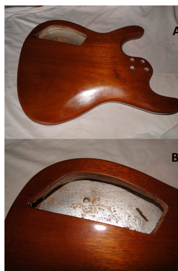
Figuras 1a e 1b – Corpo da guitarra modelo AV-1 feito de madeira tipo Cedro.
